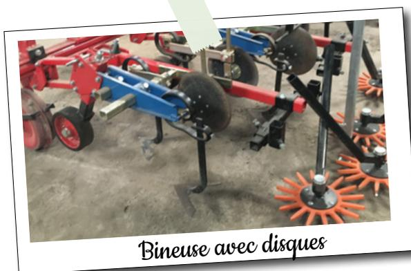
Par la suite, Bastien prévoit d'utiliser une bineuse pour entretenir sa butte. La bineuse est équipée de disques pour travailler les flancs de la butte.
